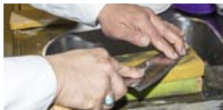
Lägg kniven platt mot slipsten. Vinkla upp den lite. Dra med jämna, stadiga och raka drag.
