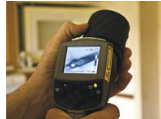
Värmekameran är ett bra hjälpmedel vid energibesiktningar. Osynliga energiläckage blir synliga.
