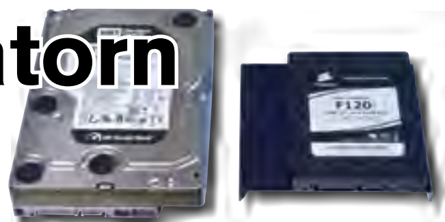
Till höger en SSD, Solid-state-drive enheter kännetecknas av att de är betydligt snabbare, tystare och mindre känsliga än traditionella hårddiskar.
