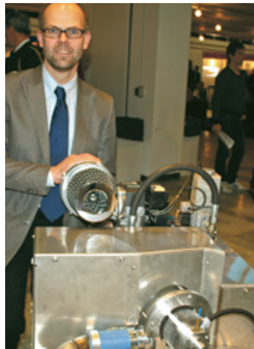
Anders Malmquist, Compower, har byggt en värmepanna med mikroturbin för framtidens villor.
