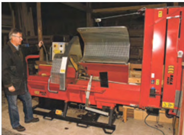
Ulf har en maskinpark för att underlätta arbetet. Han har bland annat en vedprocessor som kapar och klyver veden i halvmeterstora klabbar.
