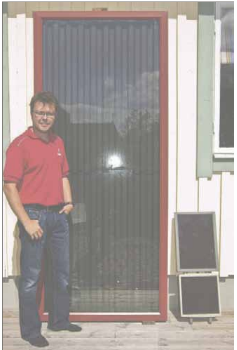
Med bättre isolering i lådan, som är byggd av gamla fönsterglas och korrugerad plåt, skulle jag nog kunna höja effekten ytterligare lite grann, säger Niklas Åkesson.
